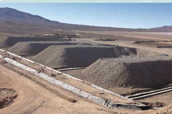
ラドミロ・トミッチ鉱山の バイオマイニング試験ヒープ
