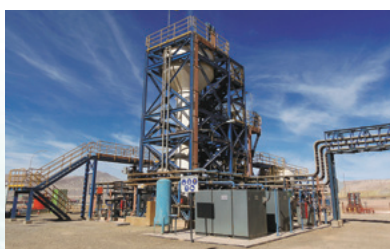
ラドミロ・トミッチ鉱山に設置された バイオリアクター(微生物の培養装置)
